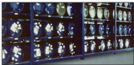
Container a scaffali per il magazzino orizzontale di fusti nel loro impiego
